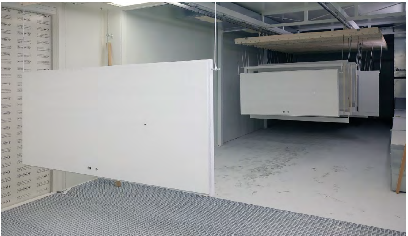
13.02 Blick in unsere Lackierkabine, in welcher hauptsächlich Grundierungen aufgebracht werden.
