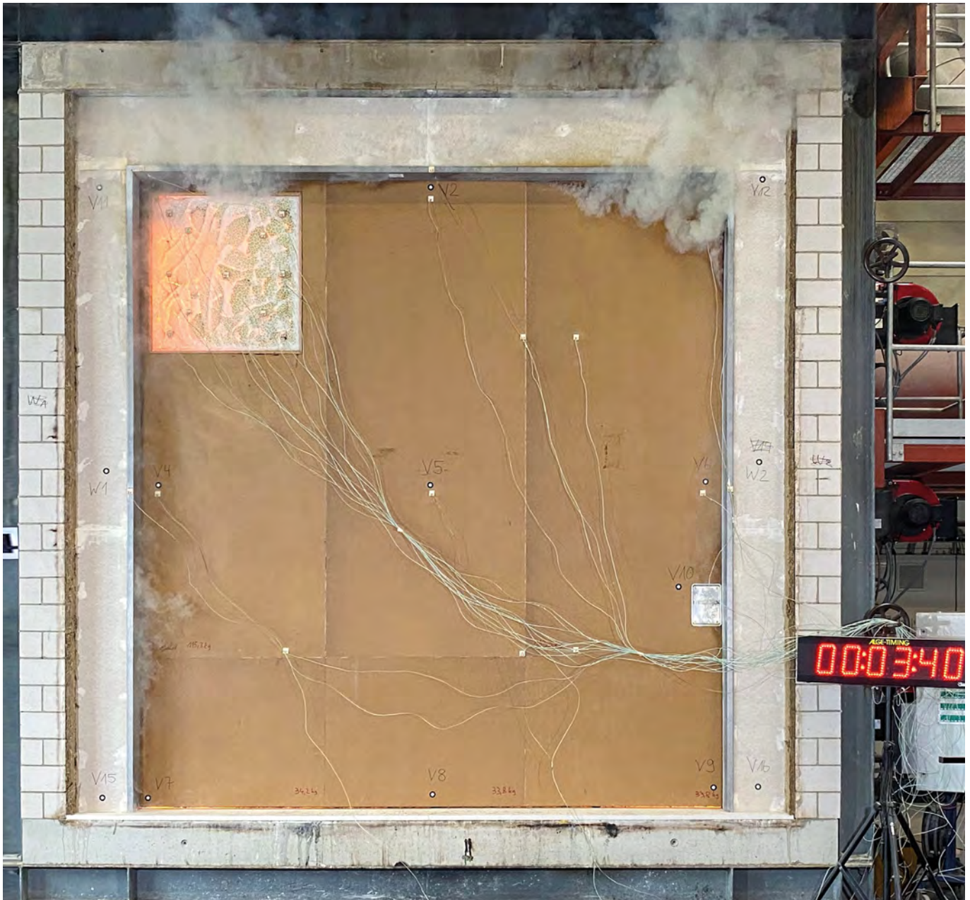
19.01 Brandschutztest unserer Mova 60 bei Minute 3:40
