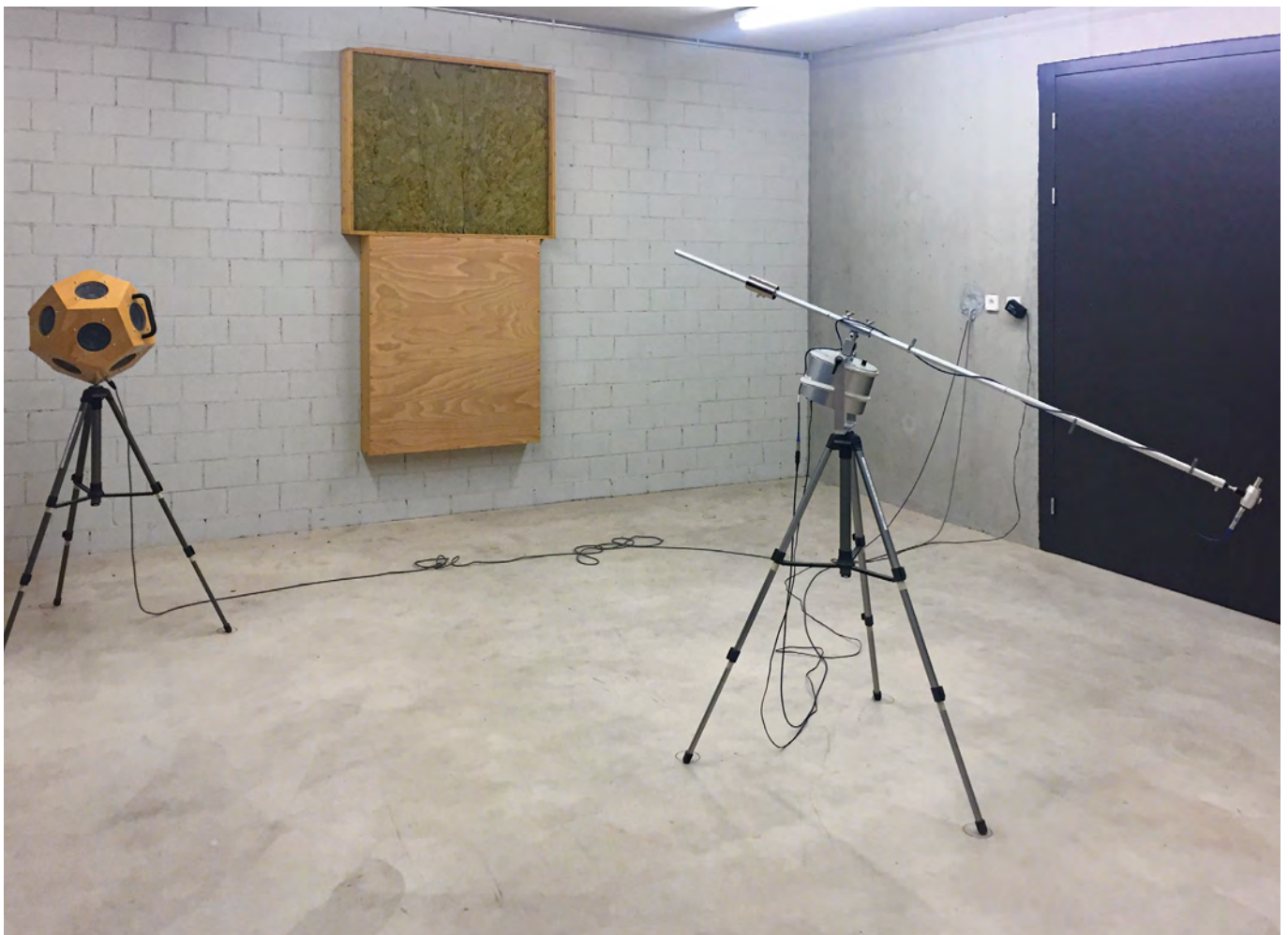
7.01 Prüfsetup im Schallschutzzlabor: Links Lautsprecher / rechts Mikrofon
