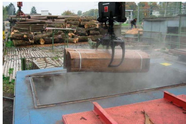
Abb. 7 | Dämpfen der Furnierblöcke
