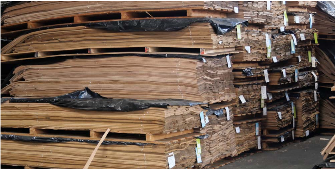
Abb. 22 | Die Lagerung gestapelter Furnierblätter ist ein natürlicher UV-Schutz.
