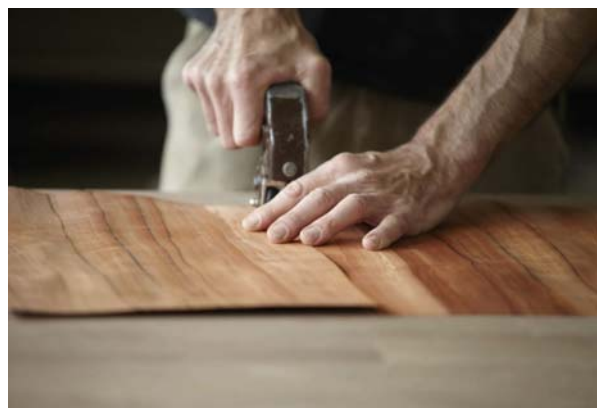
Abb. 5 | Das Aneinandernähen von Furnierblättern erfolgt händisch oder maschinell.
