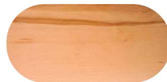
Abb. 34 | Rotkern bei Rotbuche Quelle: Schorn & Groh GmbH
