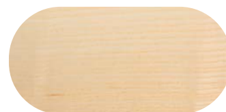
Abb. 36 | Blitze bei Esche Quelle: Schorn & Groh GmbH
