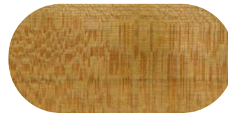
Abb. 28 | Gespiegelte Textur bei Rüster Quelle: Holzatlas
