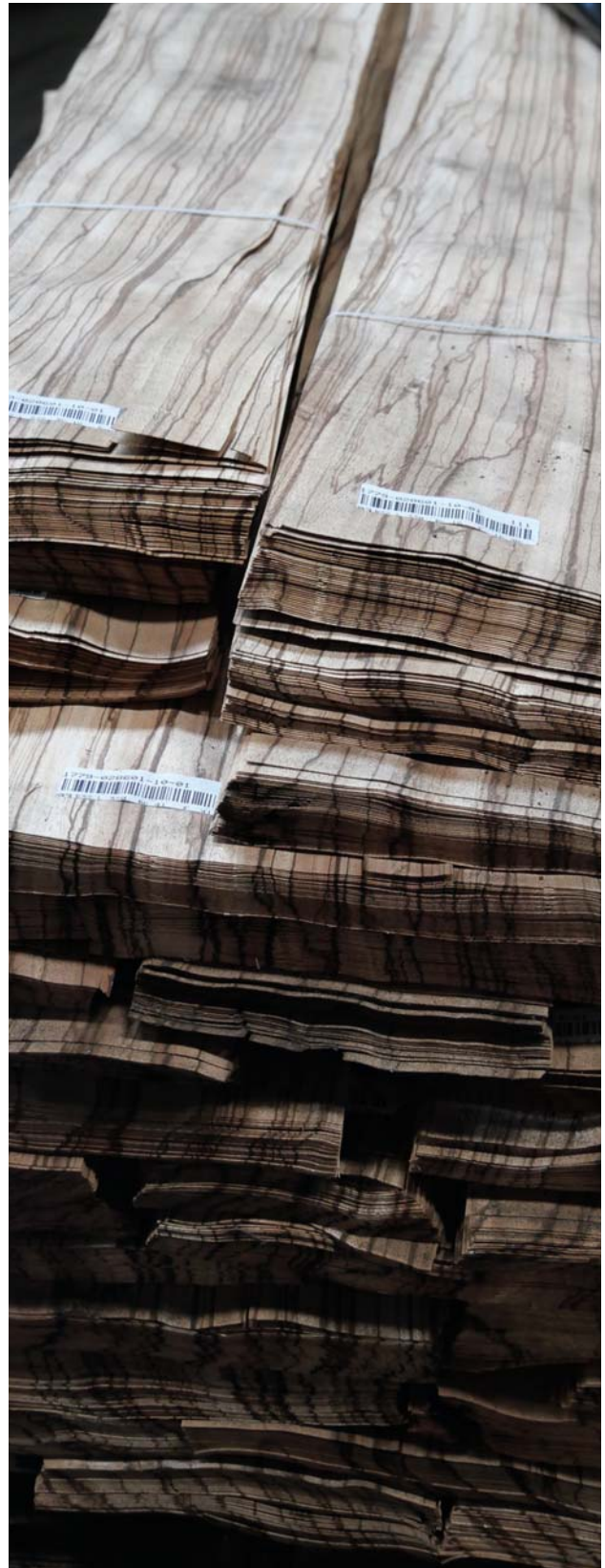
Abb. 19 | Gebündelte Furnierstapel können über Jahre gelagert werden. Quelle: IFN/Schlautmann
