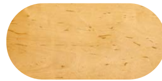
Abb. 33 | Markflecken bei Erle Quelle: TU Dresden
