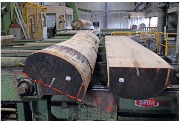
Abb. 6 | Zurichten eines Stammes
