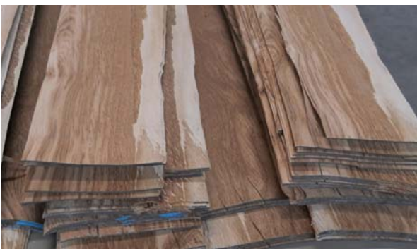
Abb. 2 | Gestapelte Furnierblätter nach dem Messern
