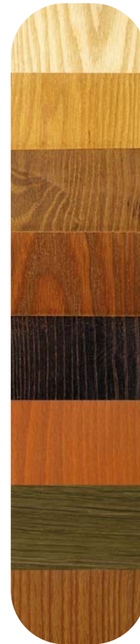
Abb. 51 | Farbtöne bei thermisch behandeltem Holz Quelle: Mirako GmbH
